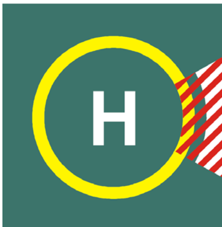
直升机甲板禁止着陆扇形区标志
